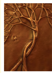
Fig. 3. Obiect decorativ din metal, obținut prin embosare
